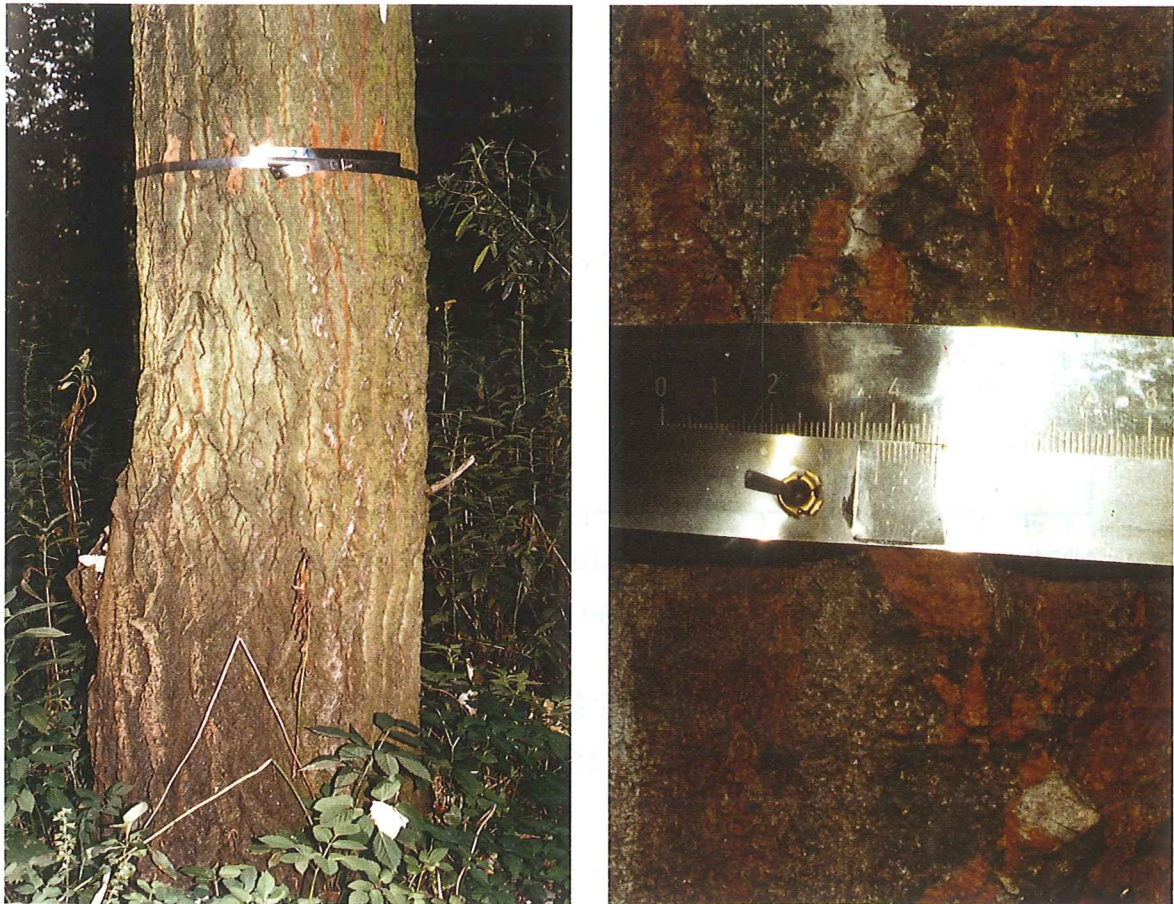
Abb. 36: Abbildung und Detailansicht eines Dendrometers.
