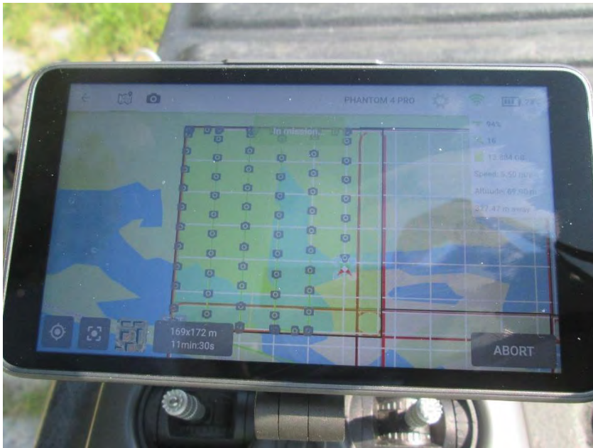
Abbildung 18: Steuerkonsole der Drohne DJI Phantom IV. Das Rote Quadrat stellt einen (von 11) Quadranten dar.
