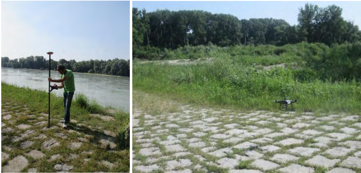
Abbildung 17: Einmessen von Referenzpunkten mittels Differenzial-GPS (links); Start der Drohne DJI Phantom IV (rechts)
