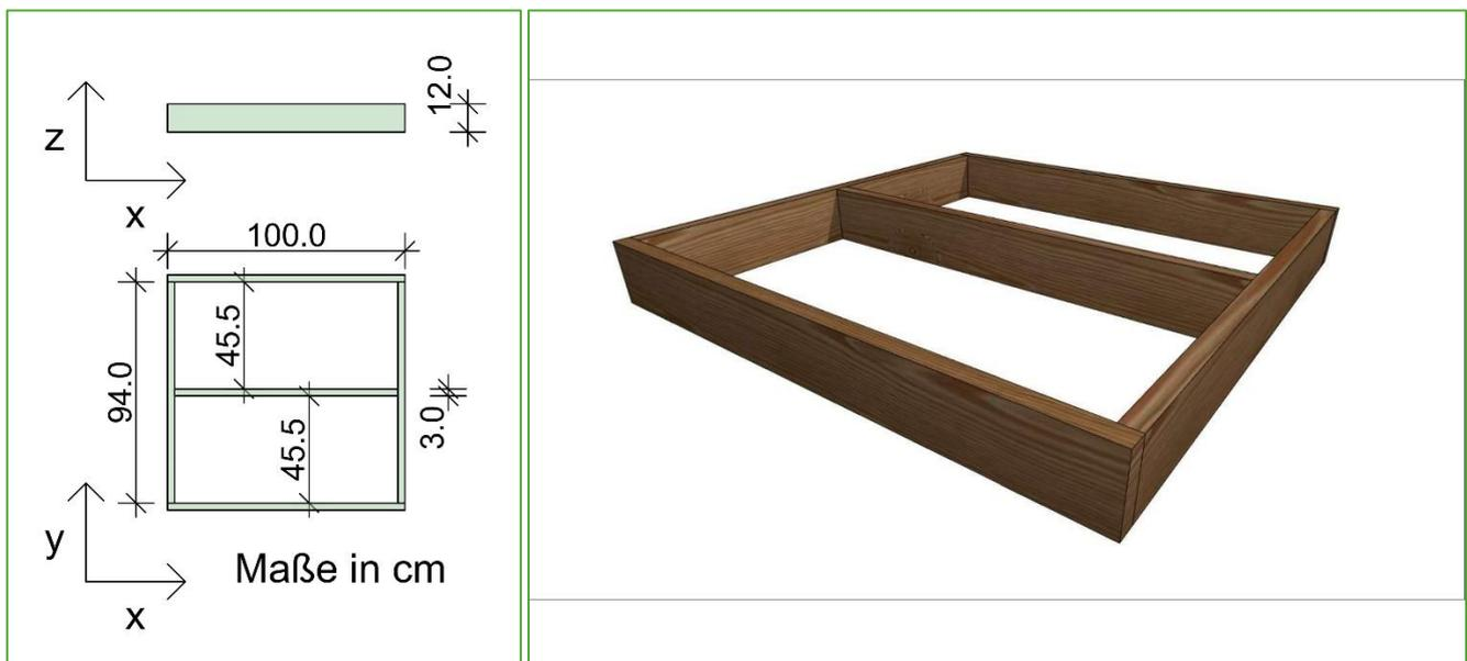
Abbildung 12: Bauplan der Rahmen für die Versuchsbeete (Angelika Bauer, 2022)
