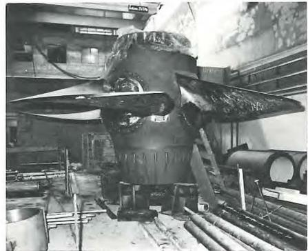
*Montiertes Turbinenlaufrad vor dem Einbau*
