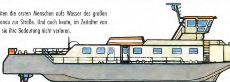
„Linz“ Zweischrauben-Schubschiff Baujahr 1969, Länge 37,8 m Leistung zweimal 1100 PS.
