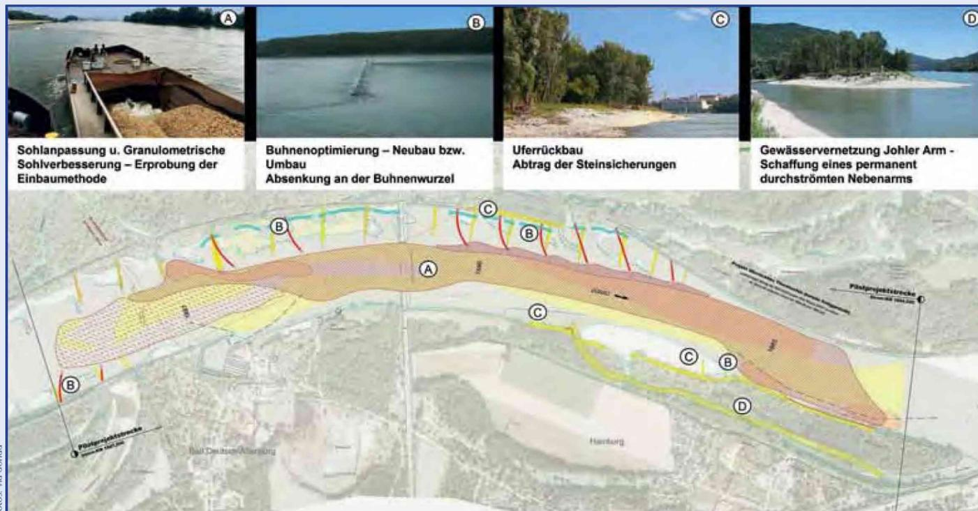
Granulometrische Sohlverbesserung, Bühnenoptimierung, Uferrückbau und Gewässervernetzung sind Inhalte des Naturversuchs Bad Deutsch-Altenburg, der bis 2014 von der via donau umgesetzt wird.
