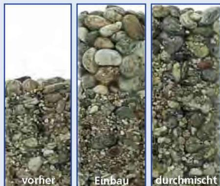
Granulometrische Sohlstabilisierung durch Einbau von 100.000 m<sup>3</sup> Grobkies: Der Strömung besonders ausgesetzte Bereiche der Flusssohle werden mit Kies von 4 bis 7 cm Durchmesser belegt, dieser durchmischt sich mit dem vorhandenen Schotter am Gewässergrund. Diese Maßnahme soll den Geschiebeaustrag verringern und dadurch die sinkenden Wasserspiegel stabilisieren.
