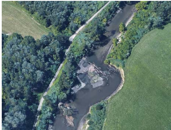
Abb. 31: Totholzanzandung im Mündungsbereich der Schwechat mit dadurch initiiertes Laufverschwenkung.
