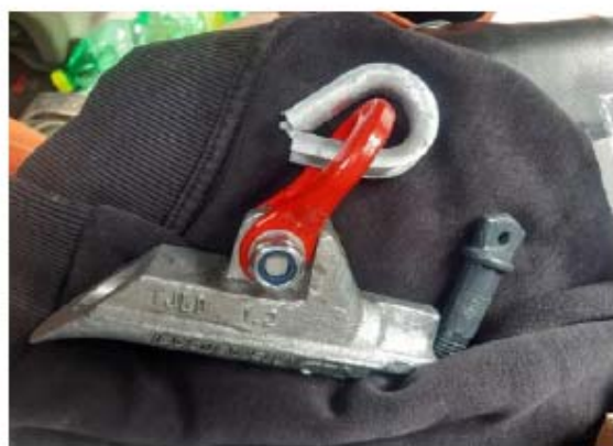
Erdanker mit eingehängter Kausche zum Schutz des Stahlseils,
